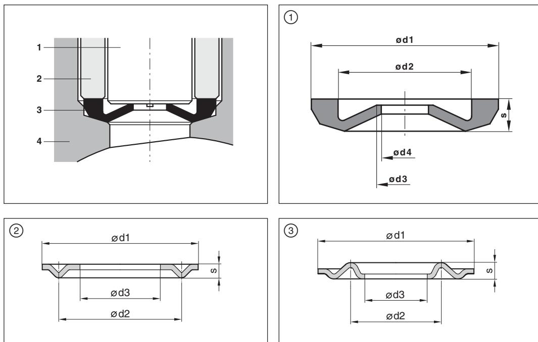
1 Drosselzapfendüse / Throttling pintle nozzle / Injecteur à téton et étranglement / Polverizzatore a pernetto strozzato / Inyector de espiga con efecto estrangulador
