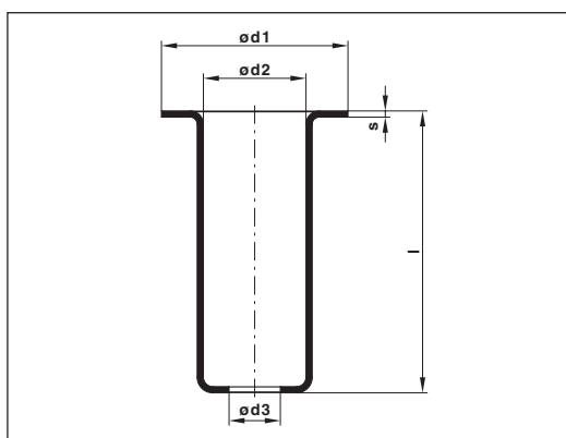
1 Lochdüse / Hole-type nozzle / Injecteur à trous / Polverizzatore a fori / Inyector de orificio
